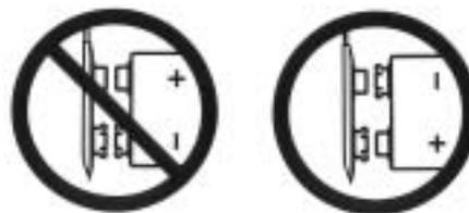
**Figure 9:** Raccords de la Batterie Smartap®.
